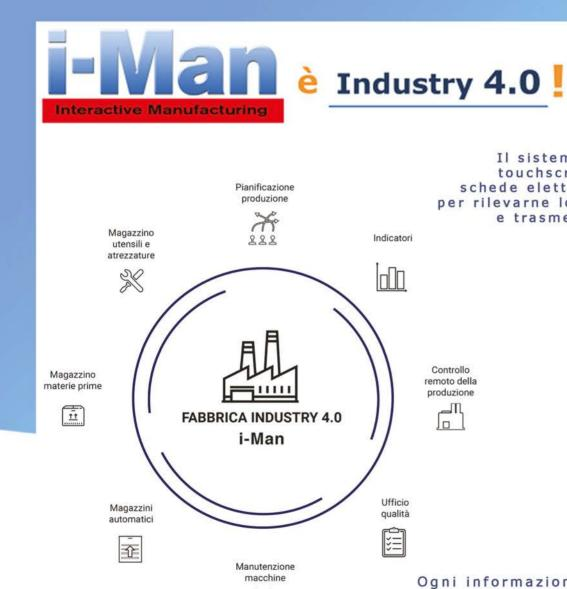
Il sistema i-Man è costituito da terminali wireless touchscreen dotati di un software web-based e da schede elettroniche che si interfacciano alle macchine per rilevarne lo stato, le quantità prodotte, per ricevere e trasmettere i part-program, rilevare i parametri macchina.
