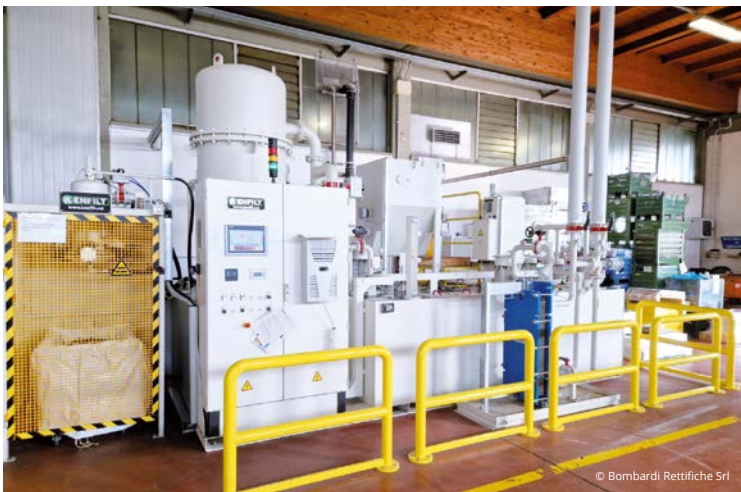
The grinding sludge filtration system and the metal briquettes resulting from their recovery. L'impianto di filtrazione dei fanghi di rettifica e i bricchetti metallici risultano del loro recupero.
