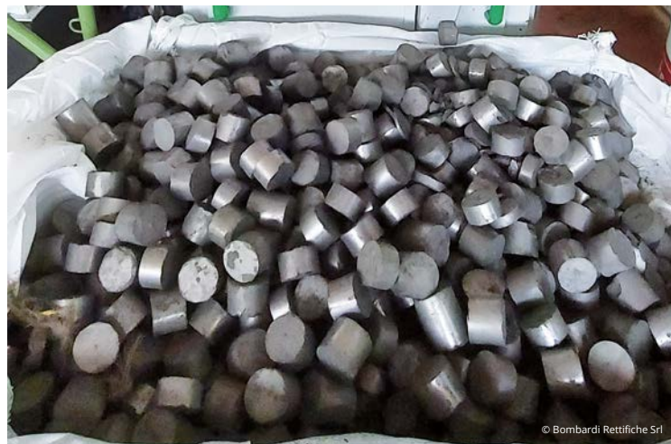
The grinding sludge filtration system and the metal briquettes resulting from their recovery. L'impianto di filtrazione dei fanghi di rettifica e i bricchetti metallici risultano del loro recupero.
