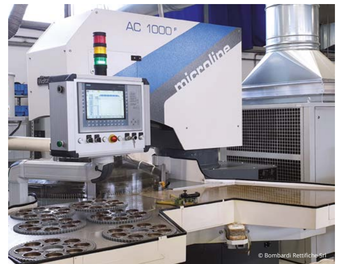
One of the two lapping machines in the factory (left) and one of the fine grinding machines. Una delle due lappatrici presenti in stabilimento (a sinistra) e una delle macchine per la microrettifica.
