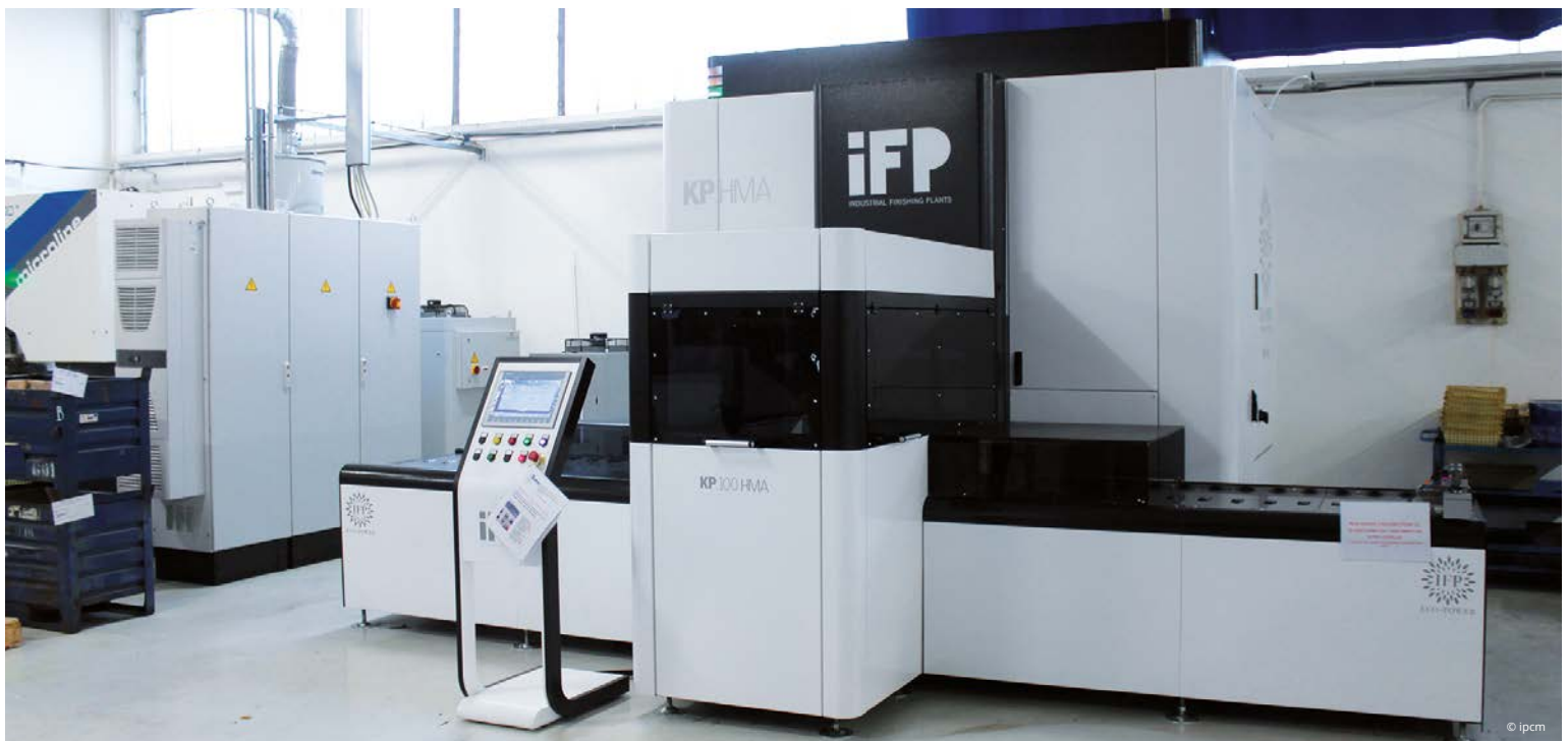
The new modified alcohol cleaning plant from IFP Europe’s KP.100 HMA series. Il nuovo impianto di lavaggio ad alcoli modificati della serie KP.100 HMA di IFP Europe.
